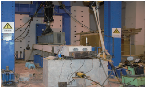
图 5 加固梁体抗压试验
