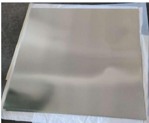
图1 厚度0.7 mm的成品NCu30板材
