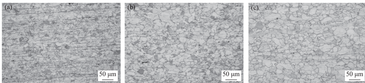
图 6 经不同固溶温度下合金的微观组织: (a) 820 °C; (b) 860 °C; (c) 900 °C
