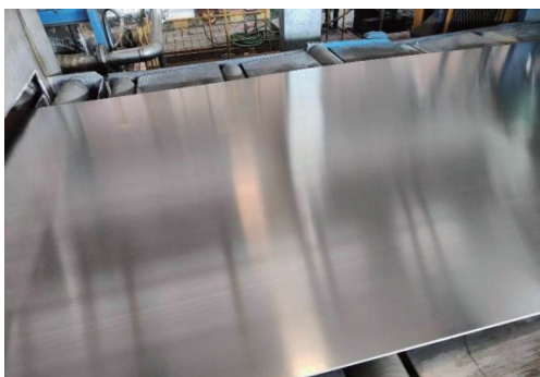
图 5 退火状态下砂带砂光后, 厚度 3.4 mm 的 NCU30 薄板
