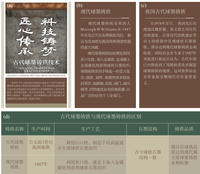
图5 郑州古荥博物馆总结的我国古代球墨铸铁与现代球墨铸铁的差异
