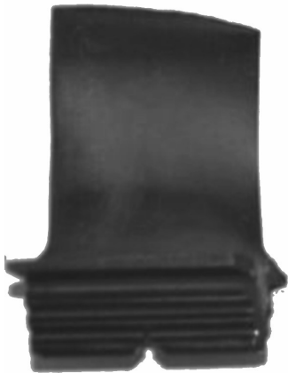
图 2 燃气涡轮一级叶片宏观形貌与变形特征
