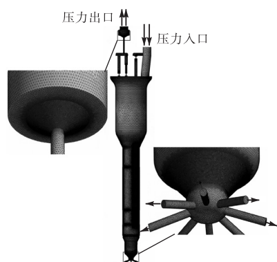
图 5 喷油器流道网格划分与边界条件设置
