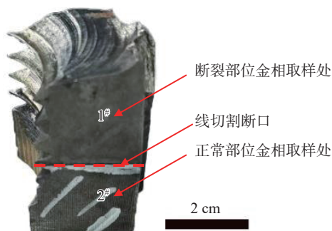
图3 显微组织取样示意图
