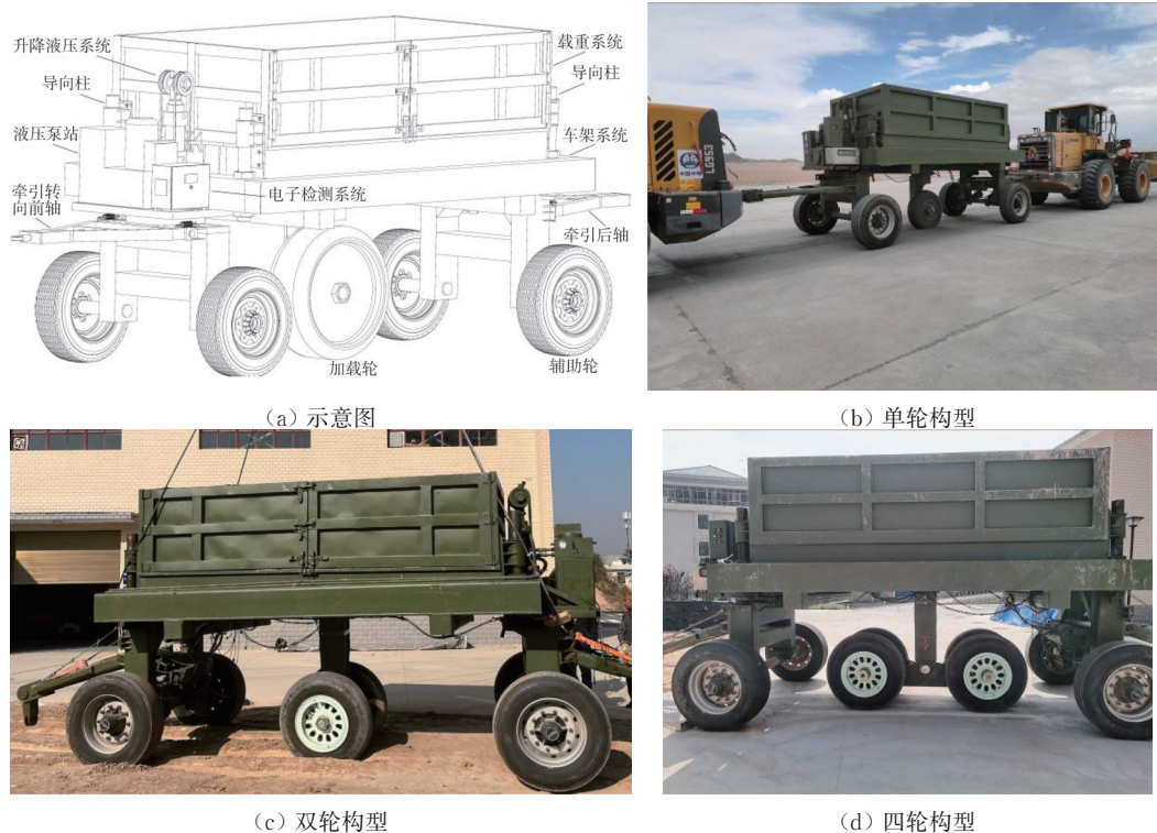
图 1 已投用的飞机荷载模拟加载车
