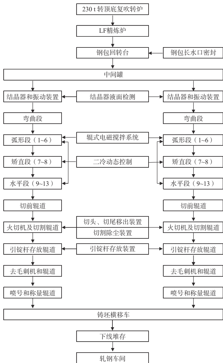
图 3 连铸工艺流程图
