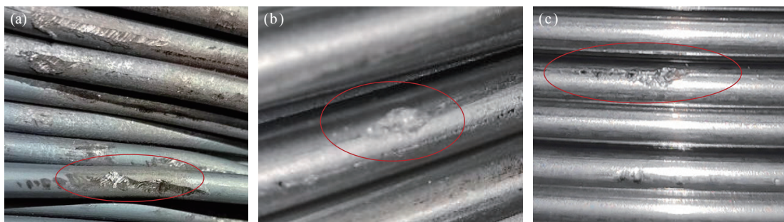
图 8 擦划伤拉拔过程中的演变: (a) 母材擦划伤表面; (b) 粗拔第一道后表面; (c) 粗拔最后一道后表面
