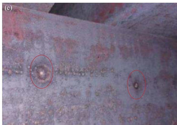
图 6 各浇次不同炉次拉速 (a-b) 及铸坯表面夹渣 (c)
