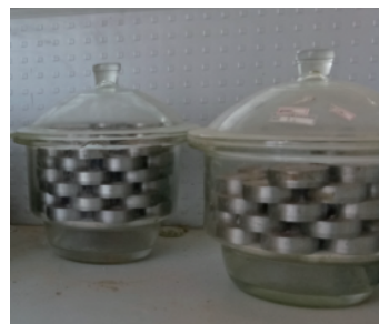
(b) 直接剪切试样
