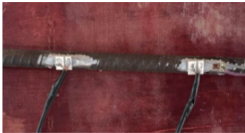
图3 粘贴PZT传感器的钢筋试件
