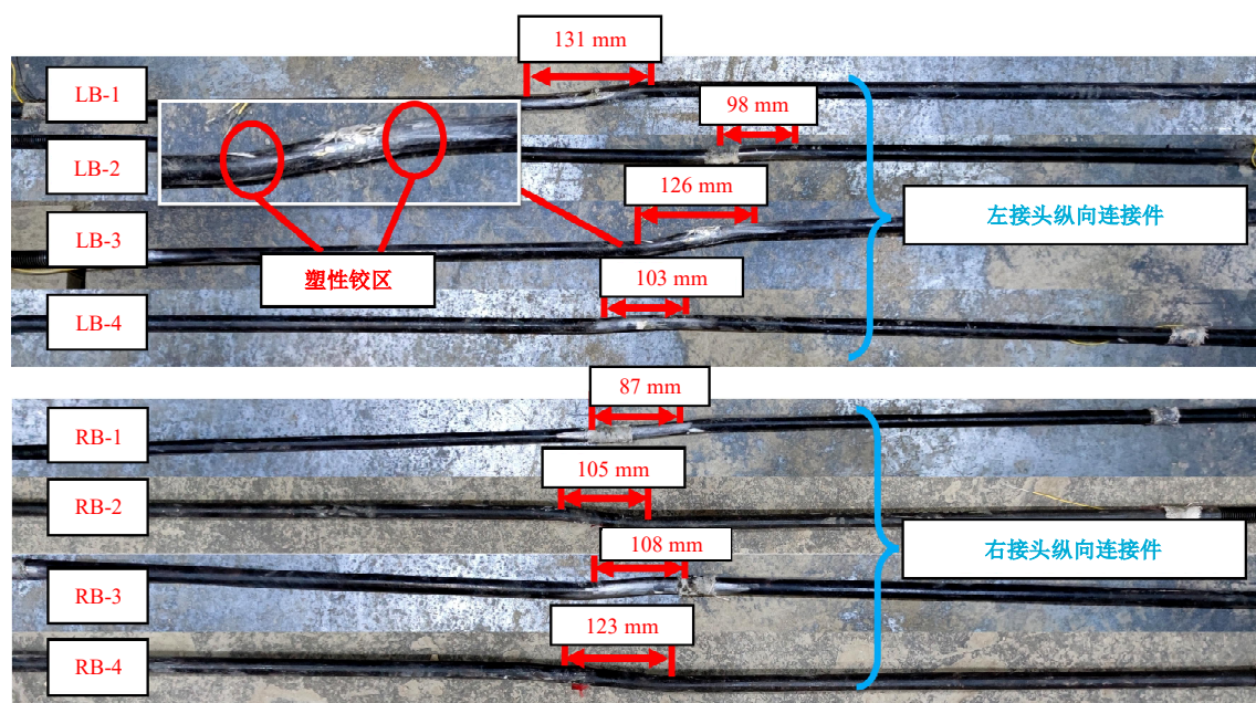
图 8 纵向连接件变形
