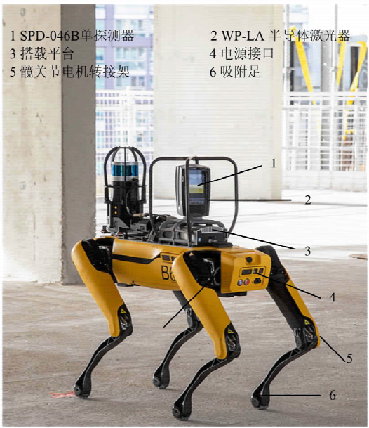
图 3 四组机器人搭载设备结构
