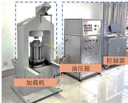
图1 泥岩蠕变试验装置
