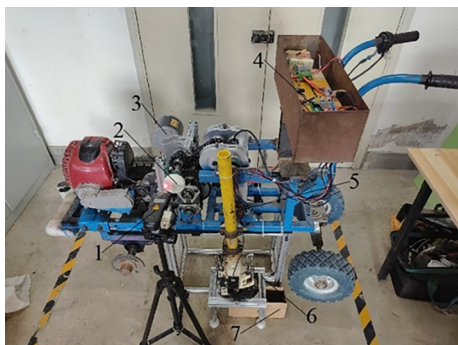
1. 非接触式光电转速表;2. 测速圆盘;3. 直流永磁电机;4. 控制器及12 V电源;5. 电控式直插式穴播器;6. 机架及底座导轨;7. 接种盒
