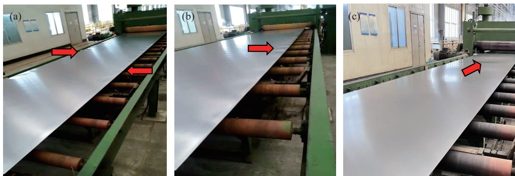
图4 冷轧过程中的板形缺陷:(a)双边浪;(b)单边浪;(c)中间浪
