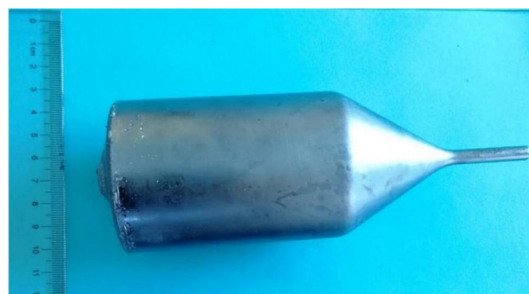
图13 大尺寸( \Phi 60 \text{ mm} )ZGP单晶 [76]
