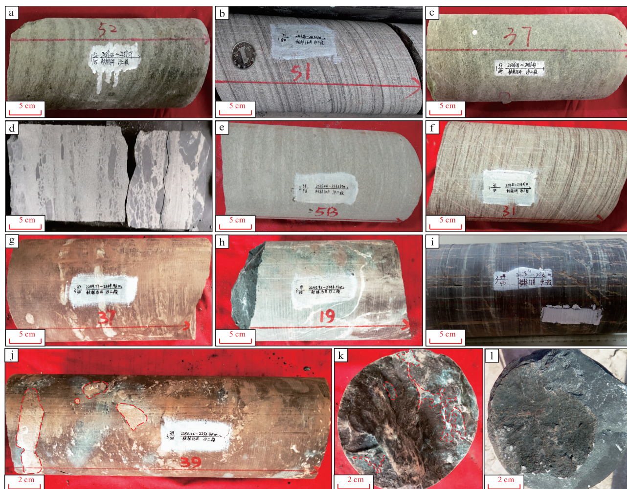
a—2089.32~2089.59 m, QL16 井, 灰绿色槽状交错层理砂岩; b—2216.80~2217.03 m, QL16 井, 灰白色平行层理砂岩; c—2086.38~2086.63 m, QL18 井, 灰绿色块状中—粗粒砂岩; d—2258.67~2258.82 m, QL202-H1 dy 井, 灰白色平行层理砂岩, 河道底部泥砾定向排列; e—2235.44~2235.67 m, QL16 井, 灰白色小型交错层理砂岩; f—2212.81~2213.07 m, QL16 井, 灰白色砂纹层理砂岩; g—2249.77~2249.96 m, QL16 井, 紫红色变形构造泥岩; h—2245.92~2246.12 m, QL16 井, 杂色泥岩; i—2378.32~2378.91 m, QL17 井, 灰黑色水平层理泥岩; j—2250.22~2250.55 m, QL16 井, 紫红色泥岩夹杂灰绿色泥岩, 可见生物扰动; k—2249.44~2249.58 m, QL16 井, 紫红色泥岩夹杂灰绿色泥岩, 可见植物根茎; l—2258.71 m, QL202-H1 dy 井, 暗色泥岩
