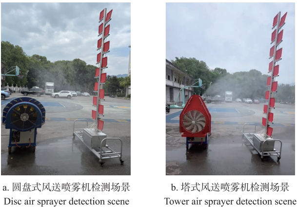
图 11 2 种风机检测场景
