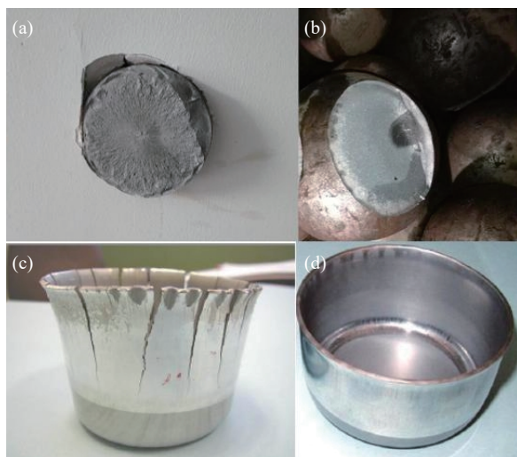
图 3 (a,b) 不含钒的磨矿钢球在静置时爆裂飞入墙体及不含钒磨矿钢球; (c) 不含钒制品外观; (d) 含钒制品外观
