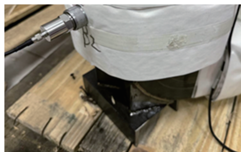
(b) 加速度传感器探头的安装
