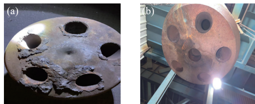
图 2 氧枪喷头优化前后侵蚀情况: (a) 优化前; (b) 优化后
