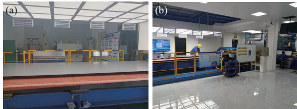
图 2 重卷机组改造后质检台: (a) 质检台处带钢上表面质检; (b) 质检台处带钢下表面质检
