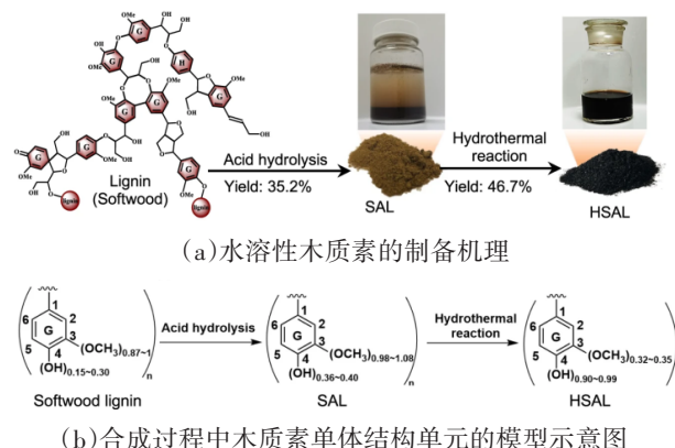
图 5 水溶性木质素的制备机理及单体结构单元模型 [16]
