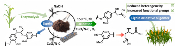
图6 氧化木质素制备工艺示意图 [31]
