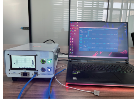
(a) 多通道温度采集系统装置
