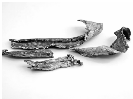
图 4 聚能装药炸毁的钢管
