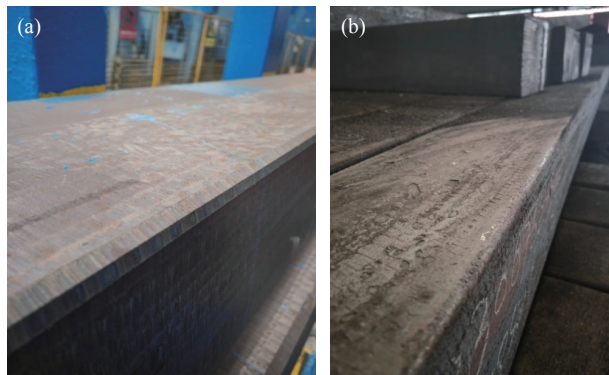
图5 倒角钢坯 (a) 与未倒角钢坯 (b)
