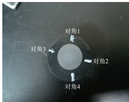
图 2 金相试样脱碳检测
