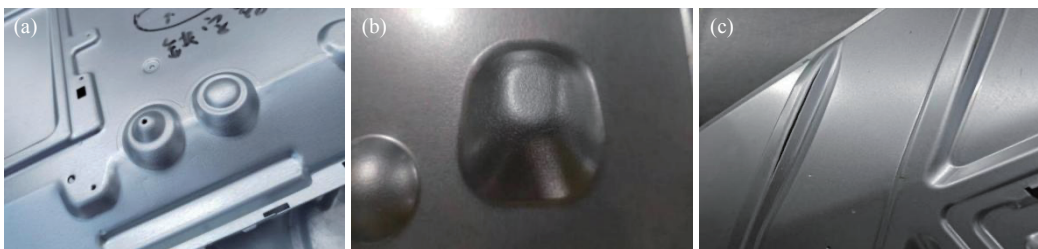
图 1 电视机背板：(a) 宏观形貌；(b) 起皱位置；(c) 开裂位置
