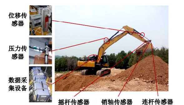
图 4 挖掘机测试方案 Fig. 4 Excavator test program
