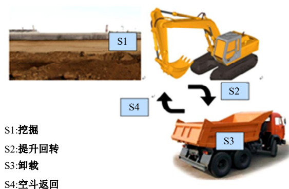
图 5 挖掘机作业的 4 个阶段
