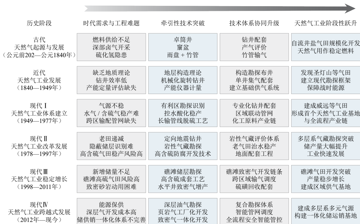
图 2 四川盆地天然气工业六阶段技术演化路径示意图
