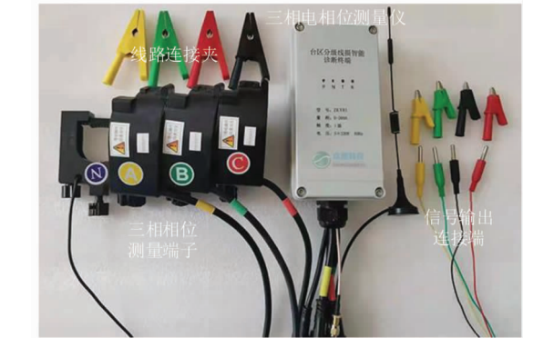
图 1 线损数据测量电力计量设备
