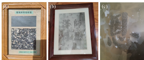
图3 (a) 鞍钢2008年生产的CGO取向钢; (b,c) 首钢博士生2022年在异常长大的取向硅钢板上通过特殊技术实现正常长大形成的“师恩泽厚”字样及其放大图片
