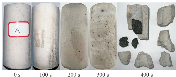
图 10 3 kW 功率下试件的力学性能演变
