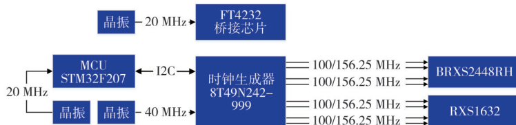
图 5 S RTP3 时钟系统框图
