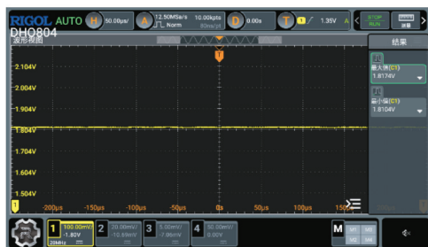
(c) 1.8 V 电源纹波测试结果
