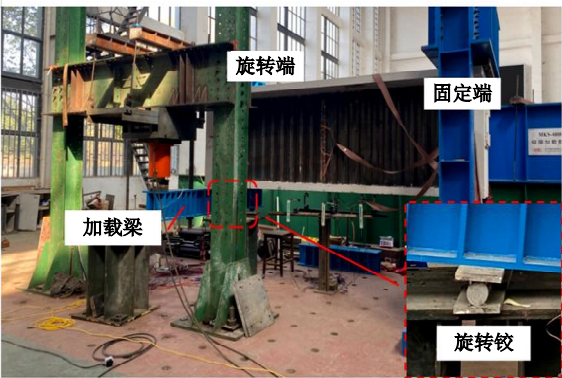
图 12 加载装置 Fig. 12 Loading device
