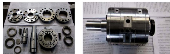
图 8 双定子凸轮转子马达样机
