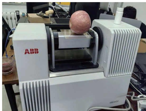
图1 苹果近红外现场采集实拍图
