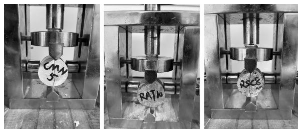
图 3 巴西劈裂试验测试抗拉强度( X_4 )
