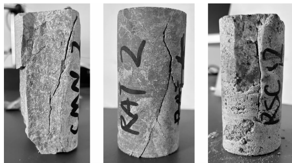
图 2 单轴压缩测试抗压强度( X_2 )
