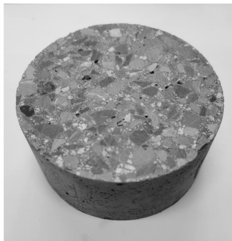
图 2 典型钢纤维混凝土圆柱形试样
