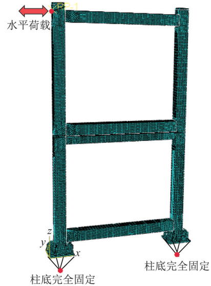
图19 有限元模型网格尺寸和边界条件
