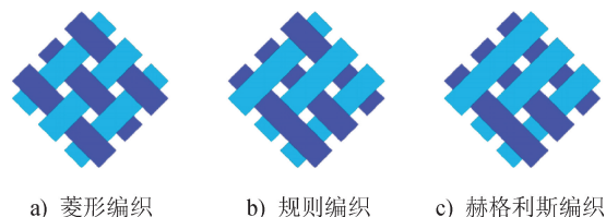
图 2 编织结构 Fig. 2 Braided structures
