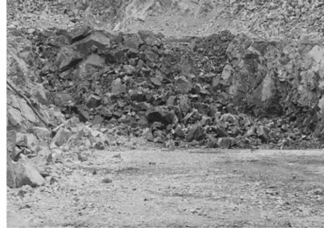
图3 掏槽爆破作业爆堆整体形态
