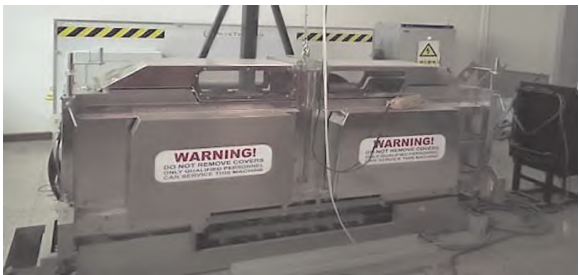
图 1 小型路面加速加载试验设备
