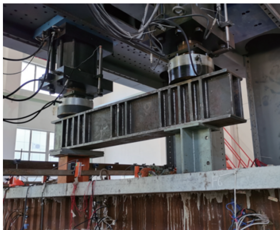
图8 试验梁中跨对称三分点加载试验
